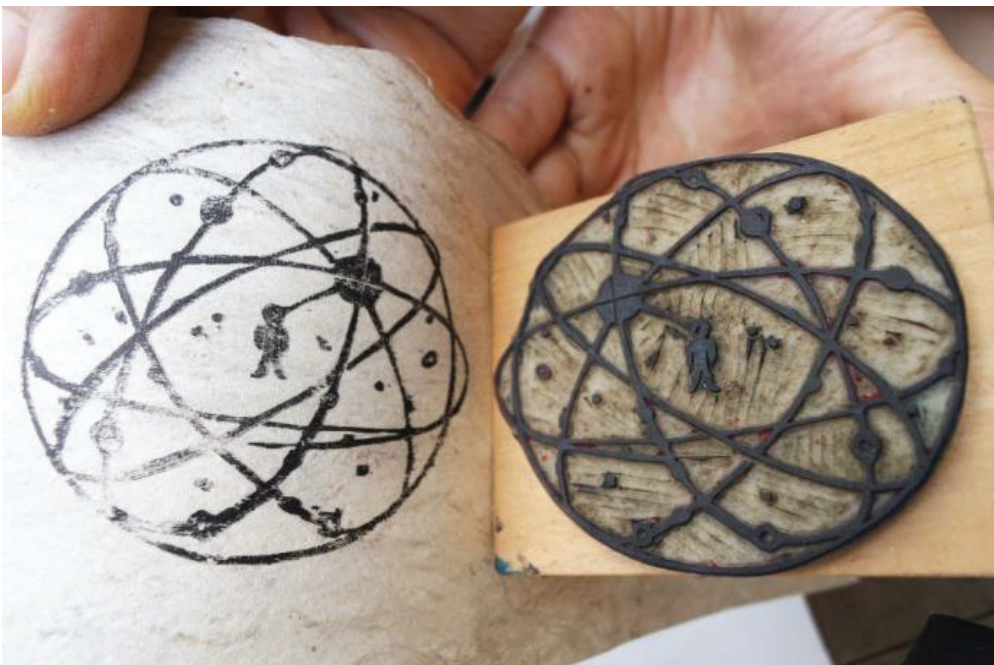
Gambar 2.12 Gambar hasil cetakan berupa kebalikan (reverse) dari acuan cetak seperti bayangan pada cermin.
