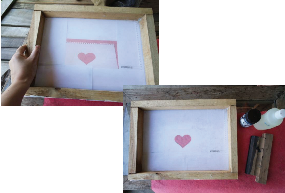
Gambar 2.21 Stensil berada di antara kertas dengan screen , sudah siap disablon.
