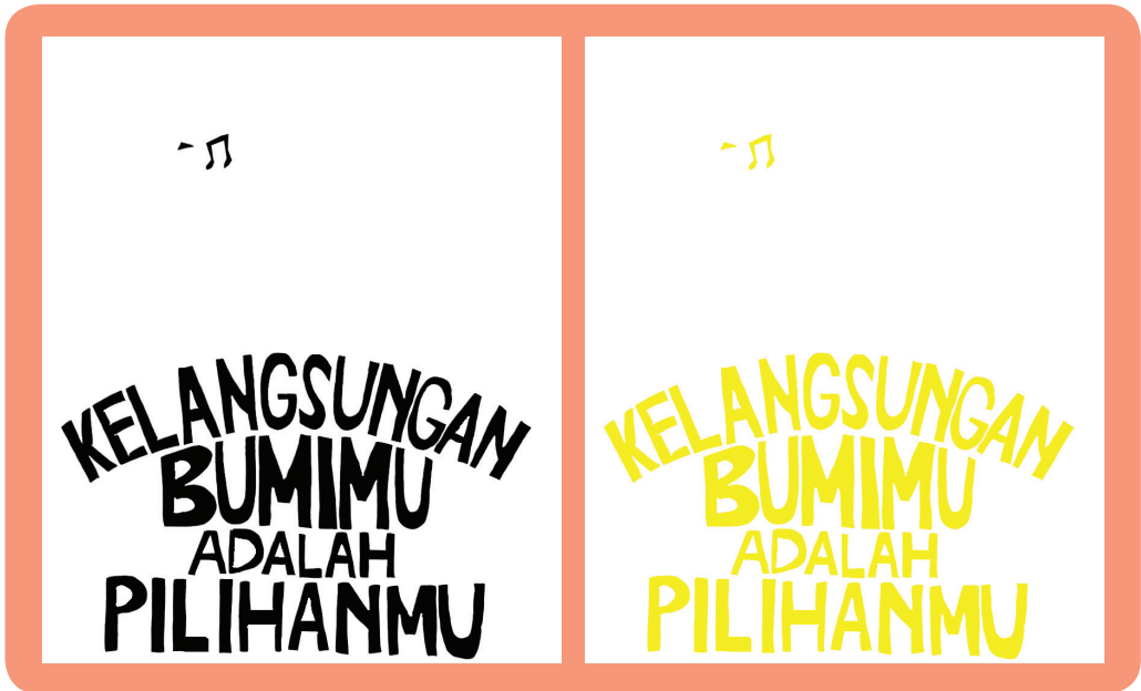
Gambar 2.36 Film untuk pembuatan acuan cetak warna kuning & hasil cetakan warna kuning (2).
