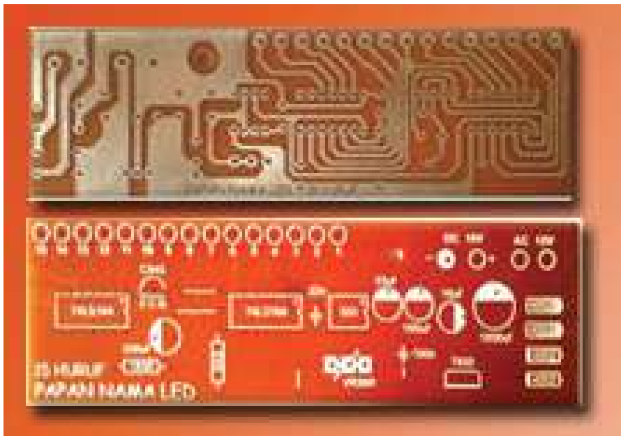
Gambar 3.6 Gambar soldering mash dan papan PCB
