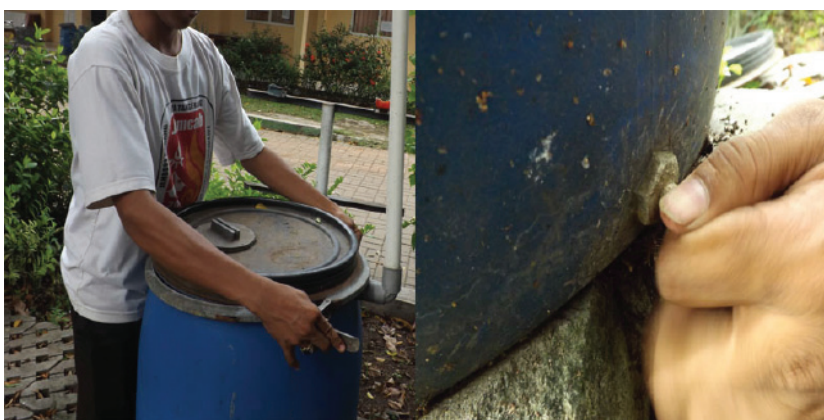
Gambar 6.17 Tutup komposter dan saluran air lindi
