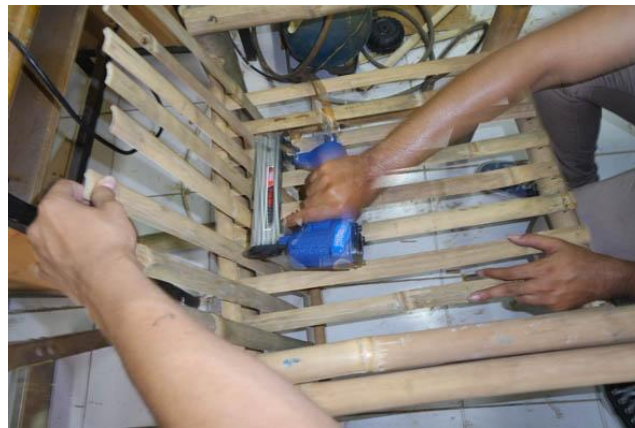
Gambar 5.19 Penggunaan Nailgun untuk penguatan konstruksi kursi pada Workshop Studi Model Kursi Bambu Ergonomis Sumber: Pribadi
