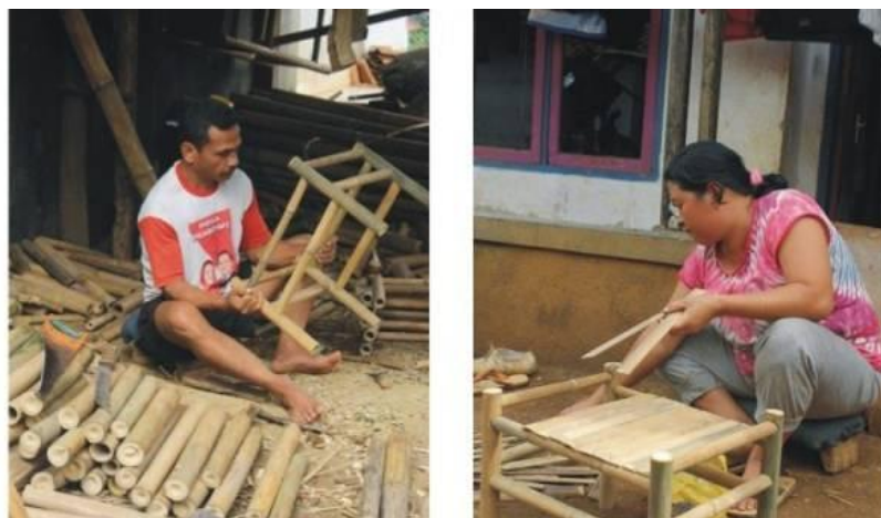
Gambar 1.2 Pak Rohana membuat konstruksi (kiri) dan Bu Rohana memasang bilah bambu (kanan) Sumber: pribadi
