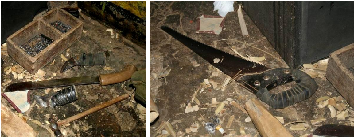
Gambar 5.5 Peralatan kerja terdiri dari golok, pisau raut, palu (kiri) dan gergaji (kanan) Sumber: Pribadi
