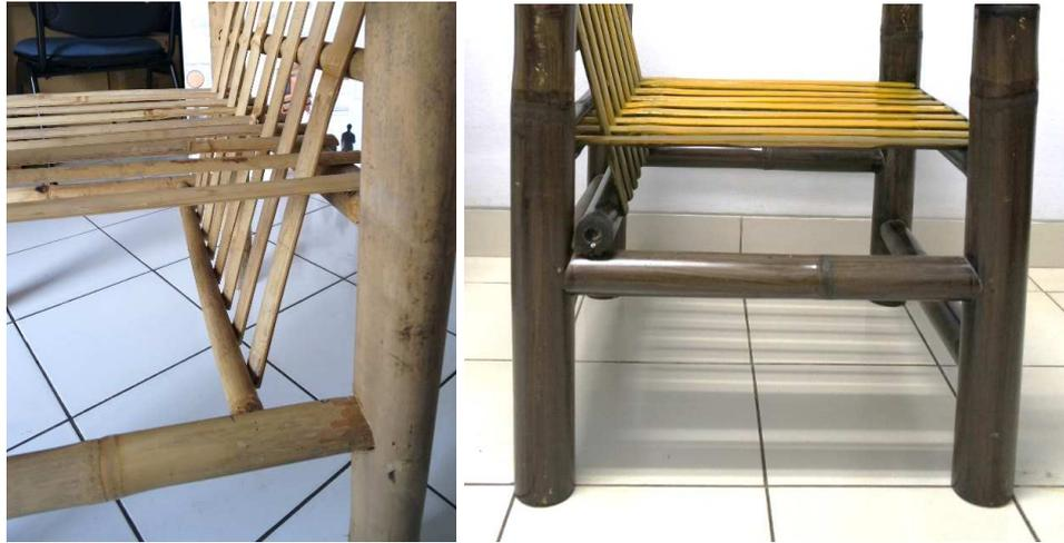
Gambar 5.11 Konstruksi kaki pada Model Versi 1A (kiri), tampak lebih estetik dan ringan daripada Model Versi 2A (kanan).
