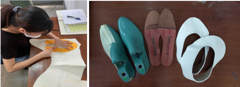
Gambar 5. Proses menjiplak pola dan pengepasan pada shoelast
