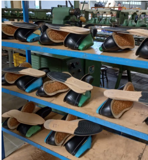
Gambar 7. Proses pengerjaan cork filler pada sol sepatu
